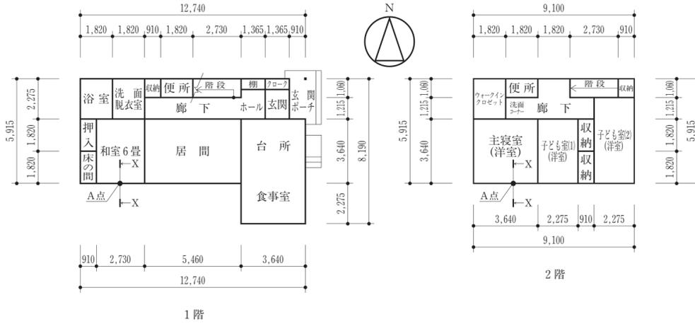
図-2 略平面図 (縮尺: 1/200、単位: mm)
