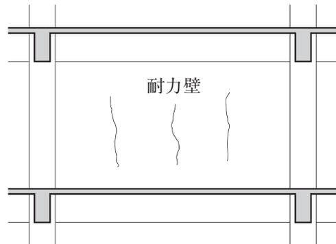
4. 耐力壁に、乾燥収縮が生じた場合のひび割れ
