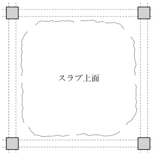
3. 周辺が梁で固定されたスラブが、鉛直荷重を受けた場合のスラブ上面のひび割れ
