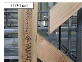
図5 筋かいの引き抜け (S-3)
