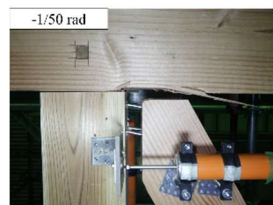
(a) 筋かいの引き抜け
