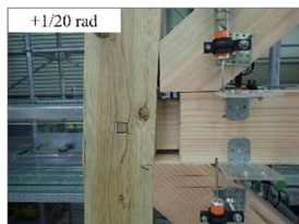
(a) 胴差の引き抜け
