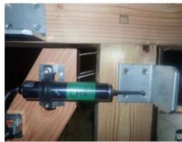
(b) 筋交いの引き抜け
