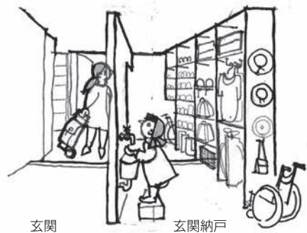
玄関わきに収納のある住宅
