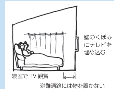
テレビをニッチ（壁の窪み）の下地材に固定して、避難通路を確保した例。
