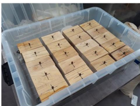
図 1 強制発錆操作
