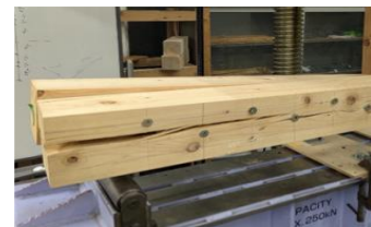
図 13 破壊性状 (ビス固定)
