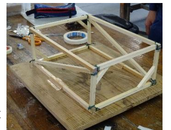
図4 加速度センサを設置する建築振動模型
