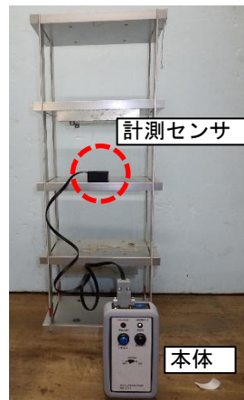
図2 建築振動模型に加速度センサを設置した様子
