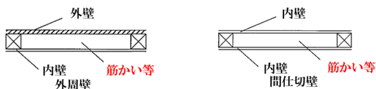
図 4-1 壁の構成(左: 外周壁, 右: 間仕切壁)
