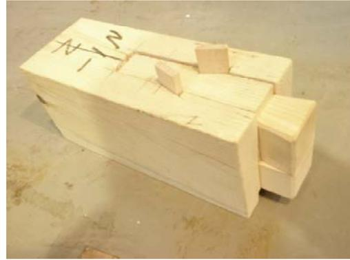
写真 23 引き独鈷（解体仕口と同じ試験体）
