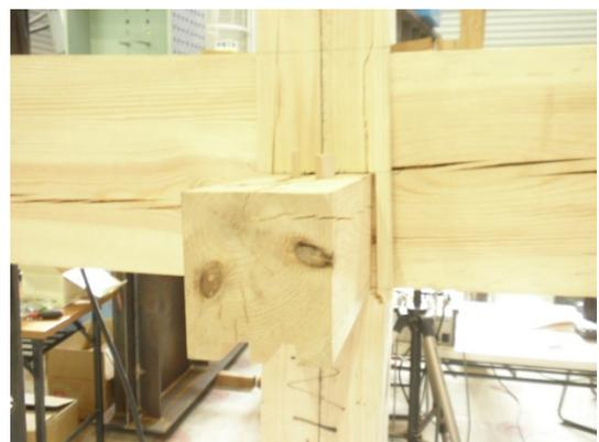
写真 27 片面鬘太の例（女木を新材に置換した試験体） 写真 28 片面鬘太の反対側と柱の折損
