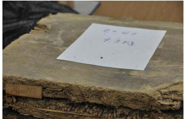
写真 16 解体時に取り出した土壁の標本(約 500mm 角)
