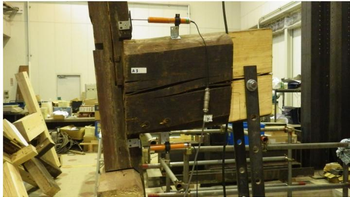
写真 29 丸太梁の柱の割裂
