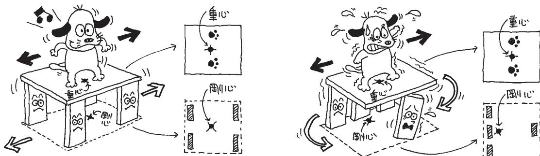
四分割法によって、耐力壁\*の配置のバランスを確認します。
