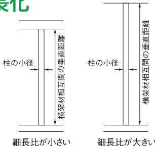
各階の柱の有効細長比が150以下であることを確認し、設計図書に明示します。
