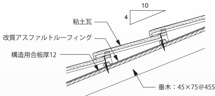
屋根ふき材の種別、屋根の断面の構造・材料の種別及び寸法(厚さ等)を明示
