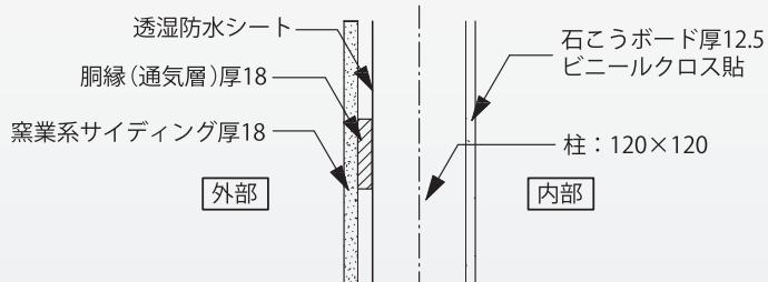
構造耐力上主要な部分である軸組等の構造方法、延焼のおそれのある部分の外壁の断面の構造・材料の種別及び寸法(厚さ)を明示
